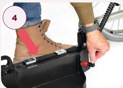
Elektrische Verbindung über Stecker und Spiralkabel
